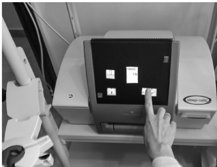
Figura 2. Carcasa de material plástico con los huecos de los iconos y botones libres donde la paciente debe presionar para el control de la pantalla.
